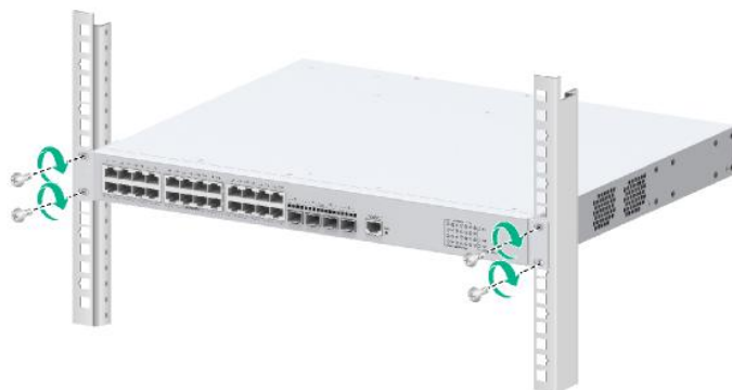
图 1-4 安装交换机到机柜示意图（端口侧挂耳安装位）
