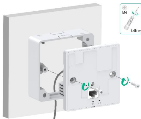
图 1-10 通过接线盒安装设备到墙面
