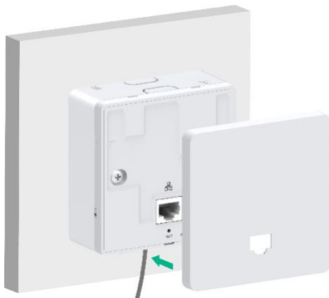
图 1-8 安装设备面板盖
