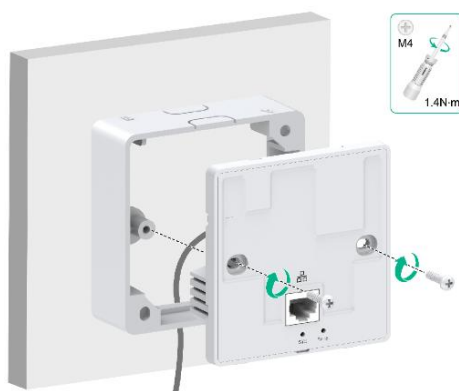
图 1-7 安装设备
