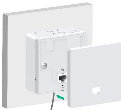
图 1-11 安装设备面板盖
