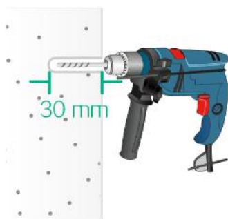
图 1-3 在墙面打孔
